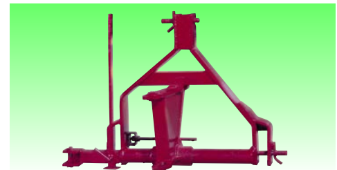
Portati con castelletto: ruote trattore entro solco. Mounted with castelletto : tractor wheels inside the furrow
