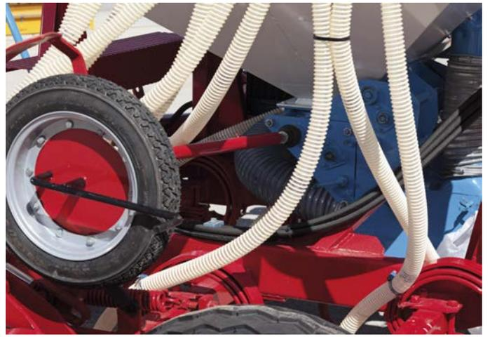
La prova di semina si esegue applicando una borsetta al dosatore e ruotando la ruota di trasmissione per 19,5 giri in senso antiorario.
