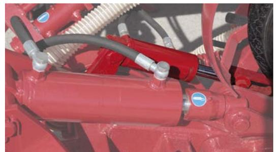
Attuatore idraulico, azionato dall'operatore dal posto guida, per disattivare la ruota di trasmissione in modo da poter effettuare lavori di ripasso con gli utensili della seminatrice evitando di far ruotare i meccanismi di distribuzione.
