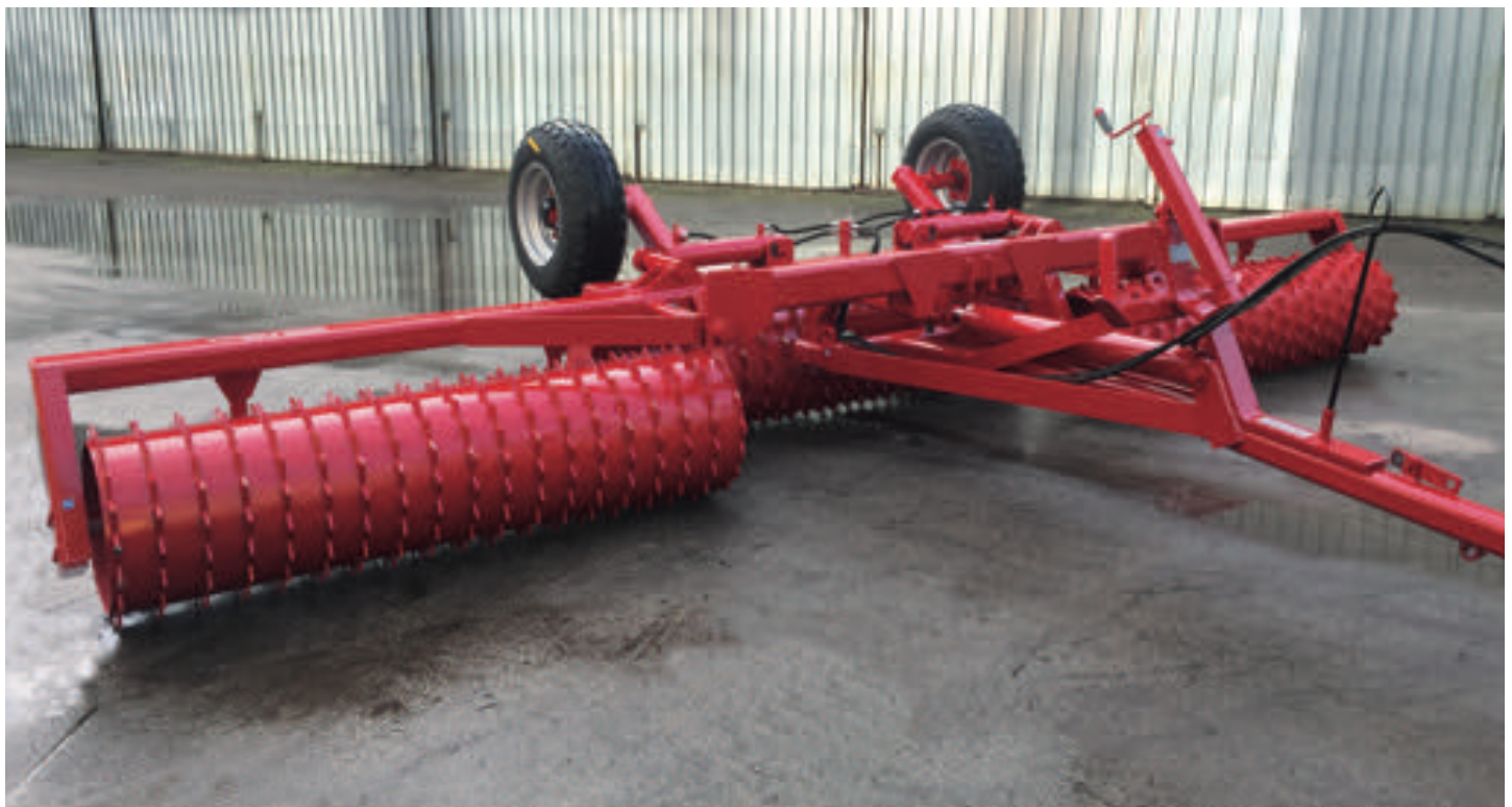
RULLO ARTICOLATO TRAINATO MT. 6,00 COMPLETO DI RUOTE E SOLLEVAMENTO IDRAULICO
