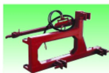
Portati a mezzo bilanciere, ruote trattore fuori solco, con lama per aratri a due vomeri, senza lama con tirante idraulico dal trivomere in poi.
