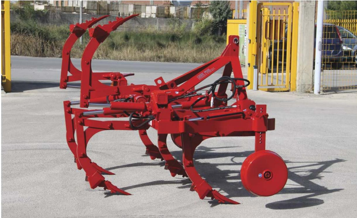
Nei dissodatori con 7 corpi è possibile chiudere i due bracci laterali manualmente grazie a delle molle di bilanciamento, difatti questa operazione è possibile effettuarla con una sola mano, mentre nel modello con 9 corpi la chiusura è idraulica.
