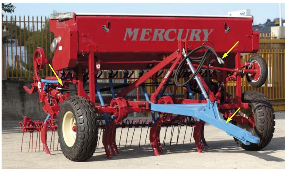
La soluzione adottata per la ruota di trasmissione le permette di ruotare su terreno non movimentato evitando di caricarsi di terra; questo accorgimento non compromette la circonferenza di rotolamento.
