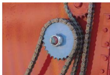
La regolazione della quantità di seme si effettua cambiando la corona primaria posta dietro il carter. Un tendicatena a molla tensionerà correttamente la catena dopo il montaggio della corona. La tabella di semina indica quale corona montare a seconda del quantitativo di prodotto che si vuole seminare. Le corone in dotazione alla macchina sono posizionate sotto la tramoggia.
