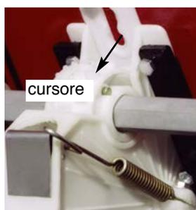
I dosatori con rullo a due corone consentono di poter seminare sementi con granulometrie e quantità diverse. La corona grande si può fare ruotare o bloccare mediante il cursorino posto all'interno del rullo. L'operazione può essere
