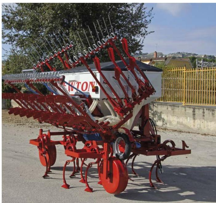
Per la chiusura della Seminatrice Newton (SISTEMA BREVETTATO) la barra porta falconi viene divisa in tre pezzi idraulicamente: i due laterali ruotano di 90° per poi sollevarsi, assieme al centrale, affiancando la tramoggia e lasciando lo spazio per la rotazione orizzontale dei semitelai del preparatore.
