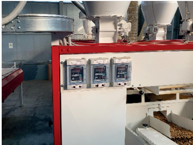
Nella cofanatura a fianco al quarto stadio sono applicati tre tastierini con display per il controllo dei giri che permettono le regolazioni del primo, terzo e quarto stadio in modo da ottenere una ottimale separazione tra gusci e frutti.
